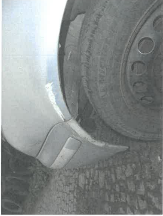
Foto 20 – uszkodzony błotnik oraz zderzak przedni
