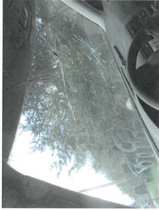
Foto 13 – popękana szyba czołowa
